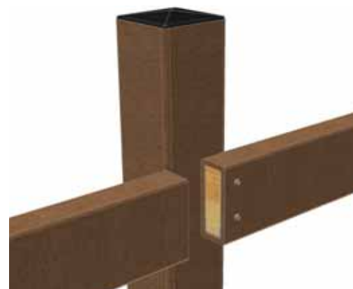
Instalación alternativa de los travesaños
