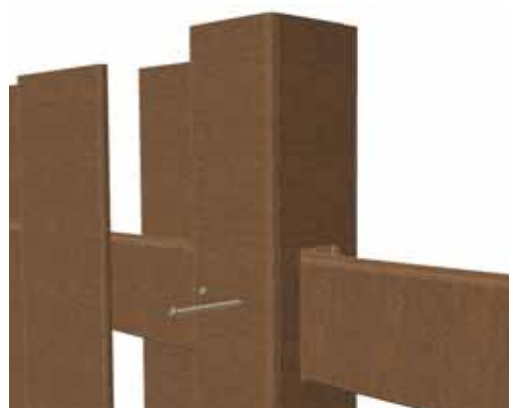
Instalación habitual de los travesaños en los postes
